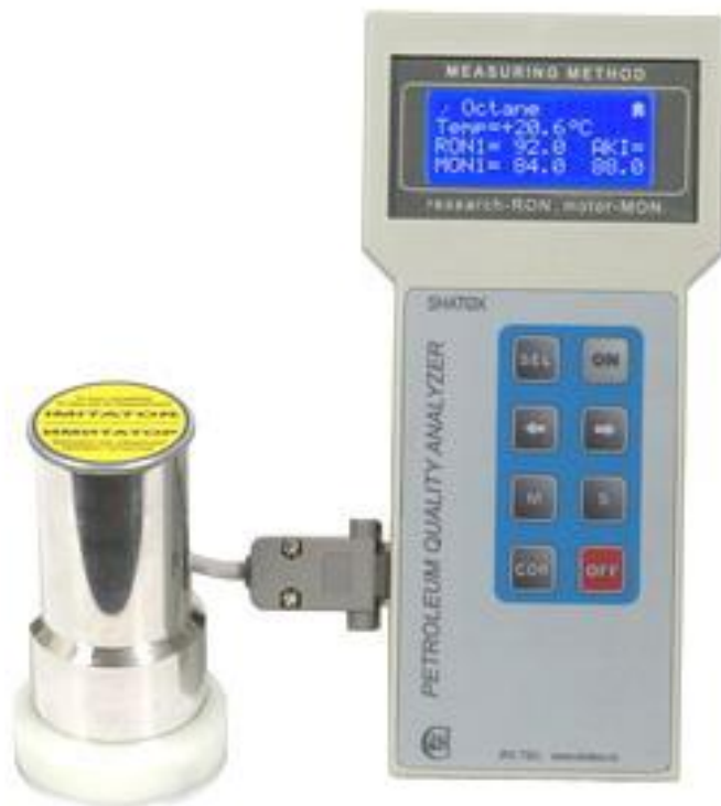
Рис. 2.1. Зовнішній вигляд октанометру SHATOXSX-150
